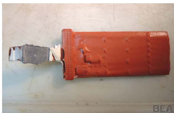
Carte électronique avec la couche de protection
