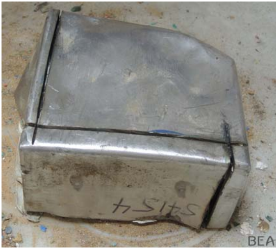
Module protégé après extraction
