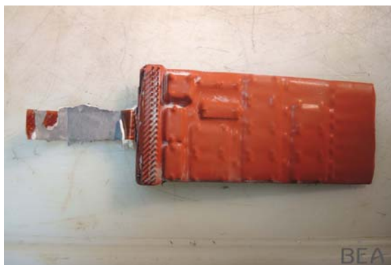
Carte électronique avec la couche de protection
