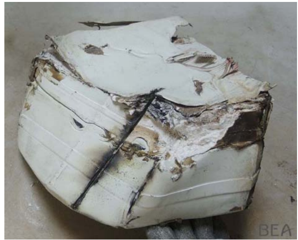
Protection thermique du support de données
